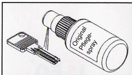
Zur Zylinderpflege den Schlüssel 2x im Jahr mit Servicespray übersprayen und in den Zylinder stecken. Schmutz am Schlüssel kann zu Beeinträchtigungen führen.
